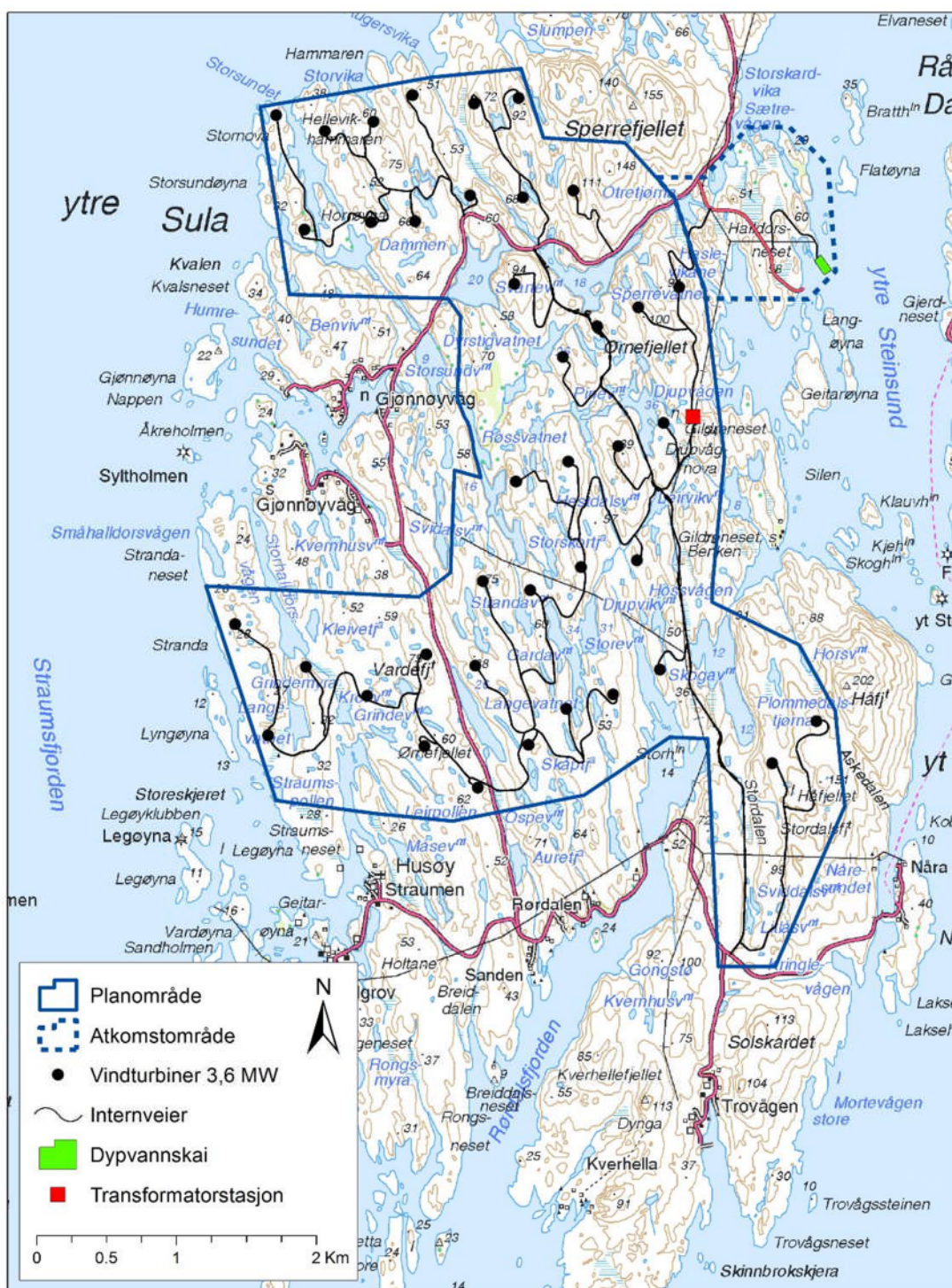
Figur 2 Utbyggingsløsning med 39 stk. 3.6 MW vindturbiner.
