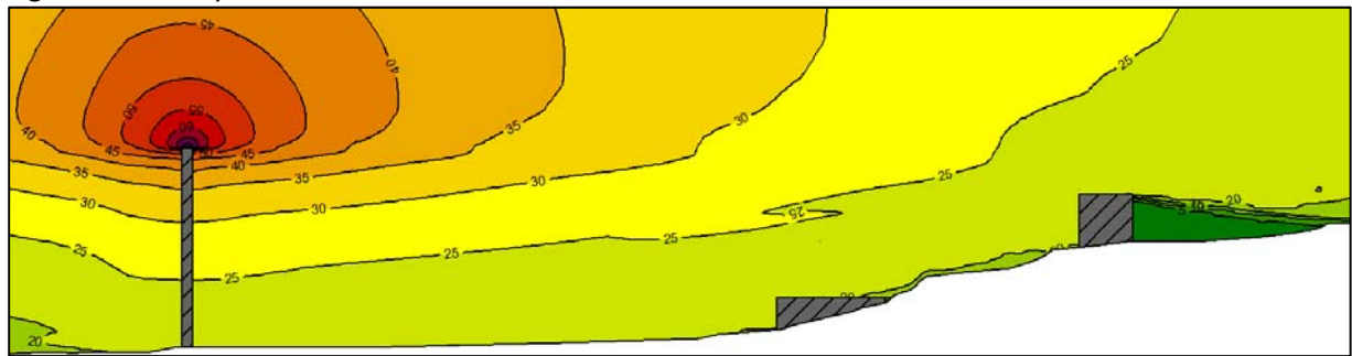
Figur 7 - Støyspredning fra skorstein, vertikalt snitt
