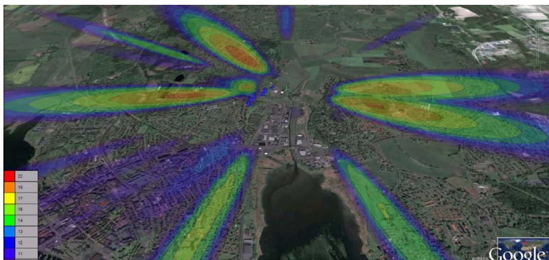
Figur 3 Maksimale bakkekonsentrasjonsbidrag av NO 2 (ug/m 3 , timemiddel) .15 MW bioenergianlegg. 30 MW oljekjeler
