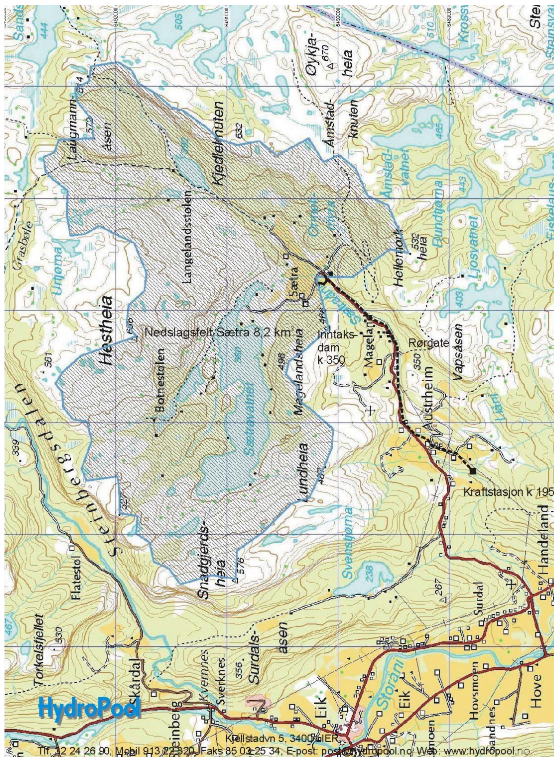
Figur 1: Kartet viser oversikt over planene for Sætra kraftverk. Nedbørsfeltet er markert med blå farge. Målestokk 1: ca 33.000 (kart utarbeidet av HydroPool).
