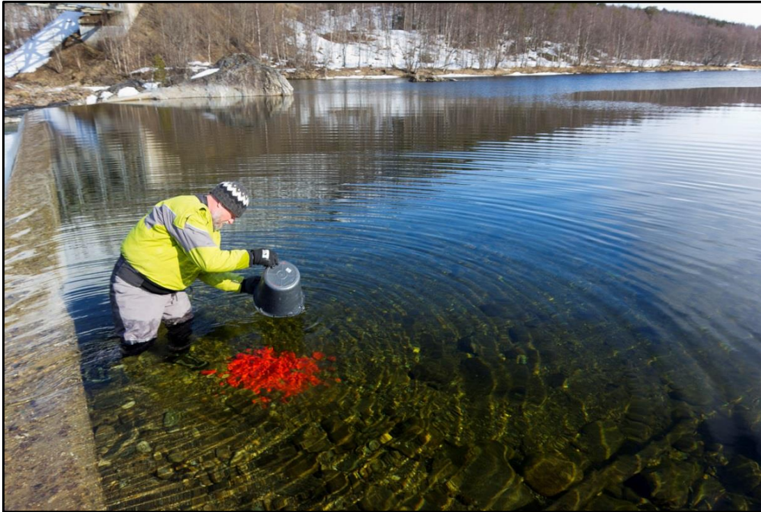
Figur 4.30. Utlekking av farget grus oppstrøms terskelen 30. april 2014.
