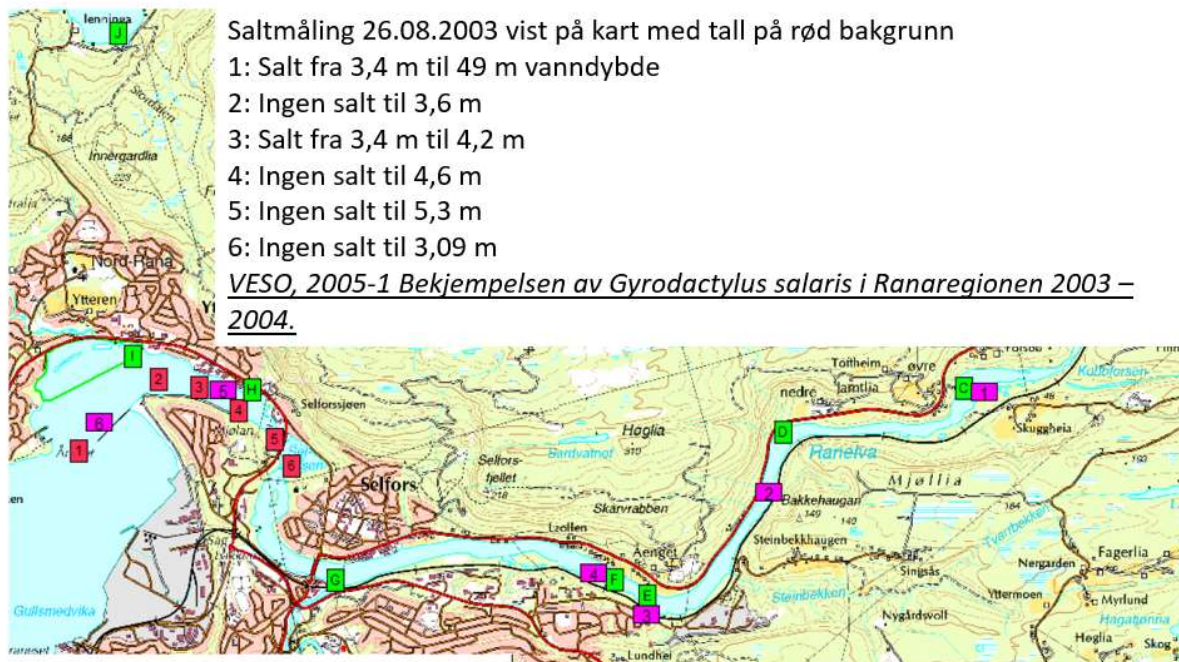
Figur 4.2. Punkter for hastighet, salinitetsmålinger og tverrsnittsmålinger i Ranaelva i henholdsvis bokstaver på grønn bakgrunn, tall på rød bakgrunn og tall på lilla bakgrunn.
