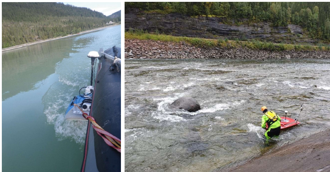
Figur 2-2. Venstre bilde viser utstyr for oppmåling påmontert motorbåt. Høyre bilde er tatt under oppmåling med fjernstyrt båt i Ranaelva. Båten ble styrt fra elvebredden, eller tilkoblet kajakk eller motorbåt, avhengig av hva som var hensiktsmessig.
