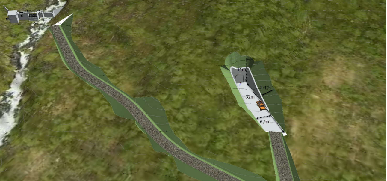
Figur 2 Planlagt utforming og antatte mål på tverrslag fra terrenngmodell. Inntak Traståna i øvre, venstre bildekant.
