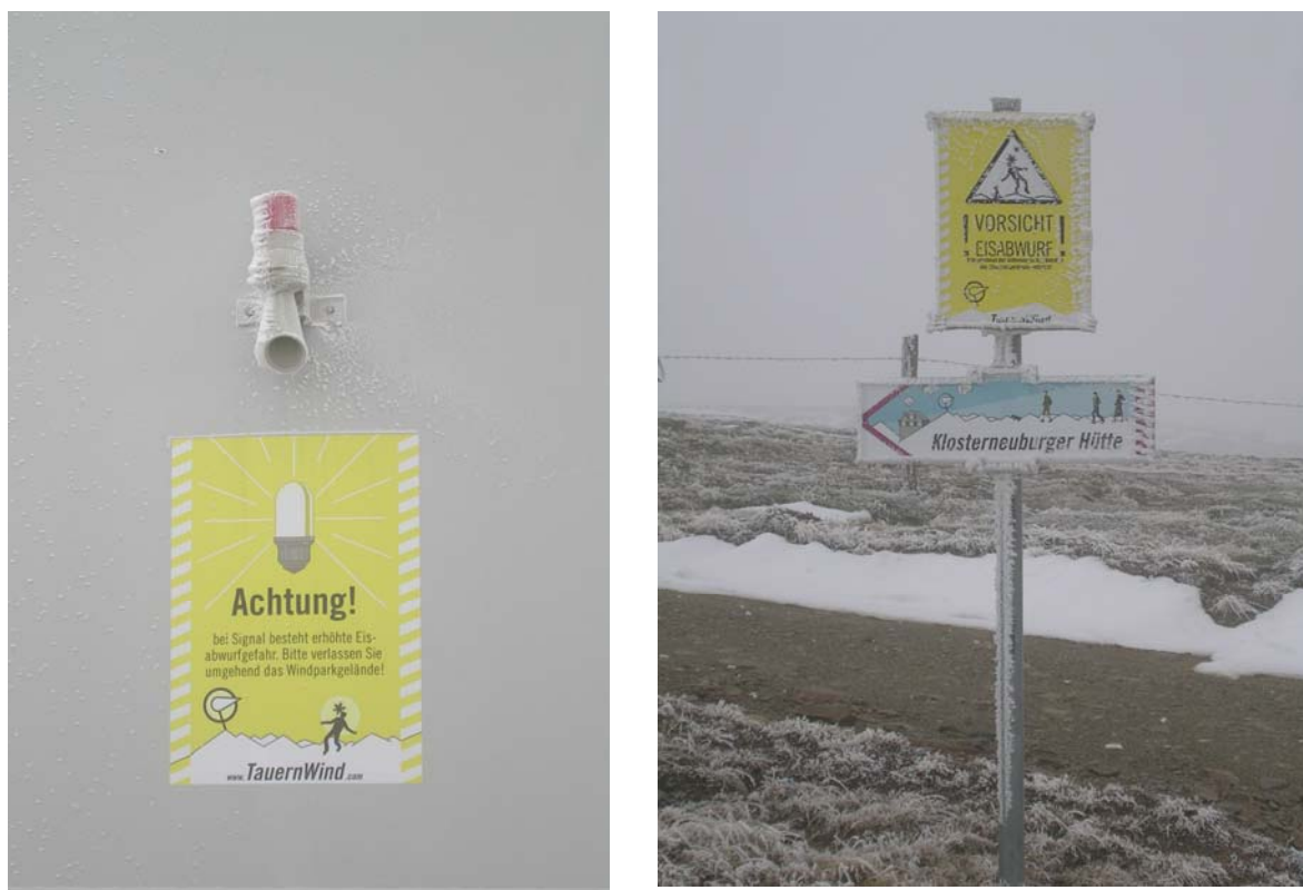
Figur 11 Eksempler på merking og varslings sirene ved fare for iskast fra vindturbiner i Sveits.
