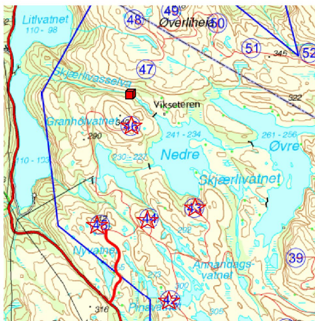
Figur 40 Vikseteren – markering av turbiner som belaster området med skyggekast
