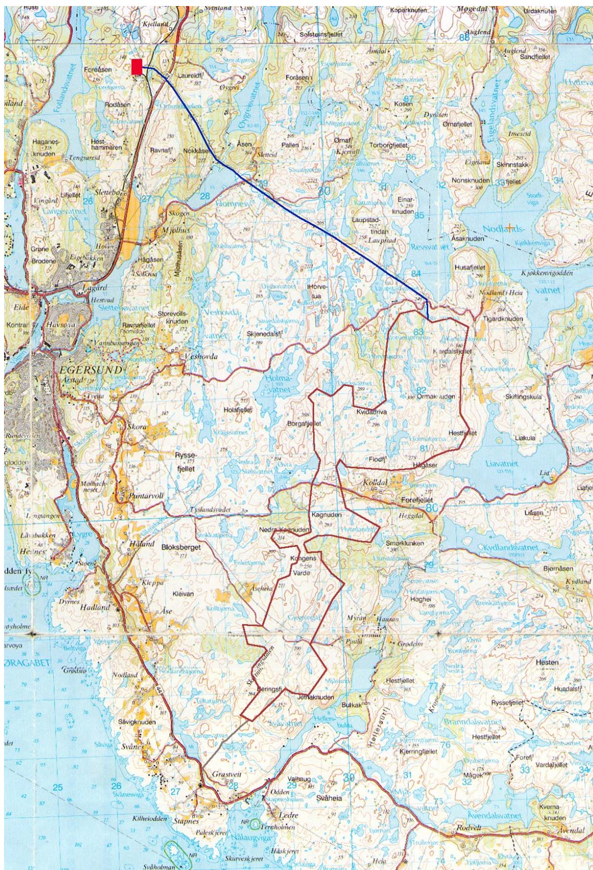
Figur 2.4. Avgrensning av planområdet for Egersund vindpark og trasé for 132 kV nettilknytning parallelt med eksisterende 300 kV-linje.
