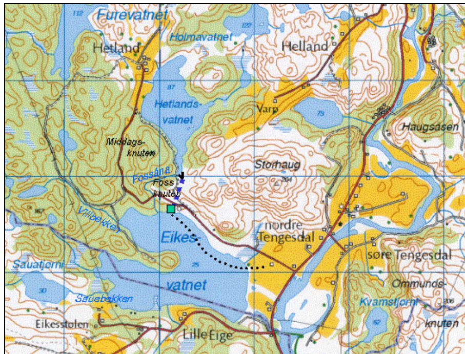
Figur 2.1 Kart over tiltaksområdet. Inntakskanalen er markert i sort, nedgravd rørgate markert med blå stipling, kraftstasjon grønn firkant og kabeltrasé som sort stiptet linje.
