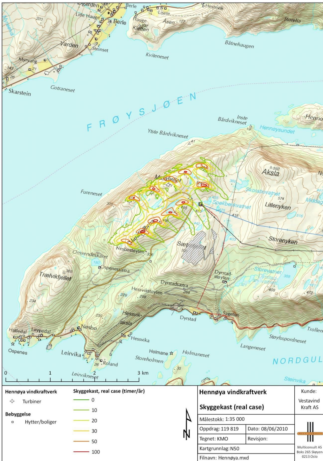
Figur 36. Beregnet antall timer med skyggekast, mest sannsynlig scenario.
