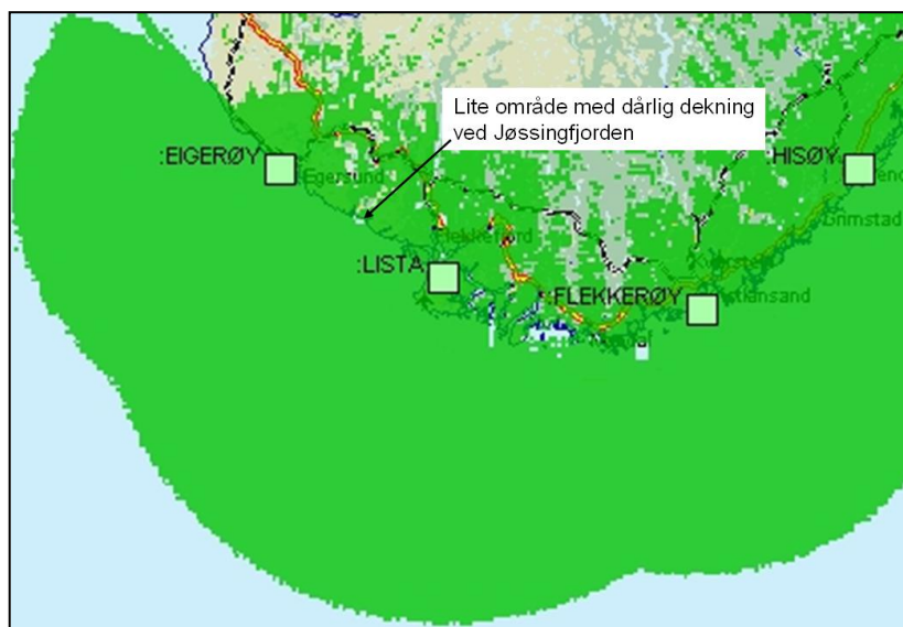
Figur 2.4 Dekning av AIS overvåkning utenfor Rogaland og Vest Agder. Den grønne fargen indikerer forventet dekning (Kilde: Kystverket).
