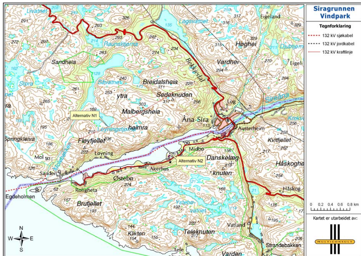
Figur 75. Ilandføring sjøkabel og traséalternativer for kraftlinjer
