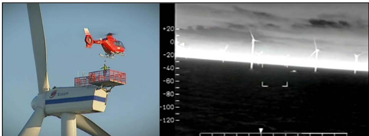
Figur 58. Helikopter benyttes rutinemessig i danske vindparker for frakting av vedlikeholdspersonell. T.h. vises IR-bilde av en vindpark tatt fra helikopter (Kilde: Vestas og MCA).
