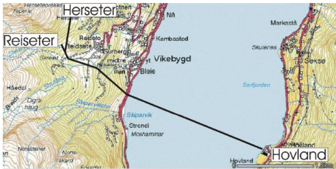
Figur 1. Overordna plan for tiltaket. Vatnet skal samlast kjelder på vestsida av Sjøfjorden og førast over fjorden til fabrikk på Hovland.
