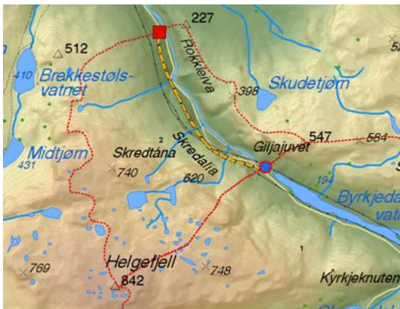
Figur 2-1 Kart over tiltaksområdet med inntak i Byrkjedalsvatnet (blå sirkel), tunnel og kraftstasjon (rød firkant).
