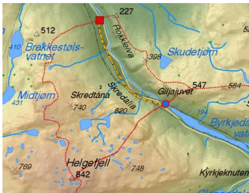
Figur 3-1 Kartskisse over planlagt tiltak. Inntak er vist som blå sirkel og kraftstasjon som rød firkant. Tunnelen er vist som gul stiplet linje. Hydrologiske konsekvenser er vist for et punkt rett nedstrøms inntaket, og et punkt rett oppstrøms utløpet.
