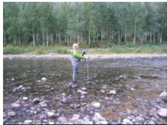
Vannføringsmåling ved Fotopunkt 19. august (0,29 m 3 /s).
