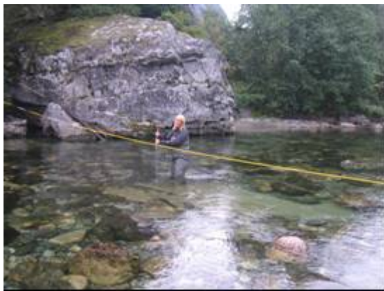
Vannføringsmåling ved Finnset 18. august (0,70 m 3 /s).
