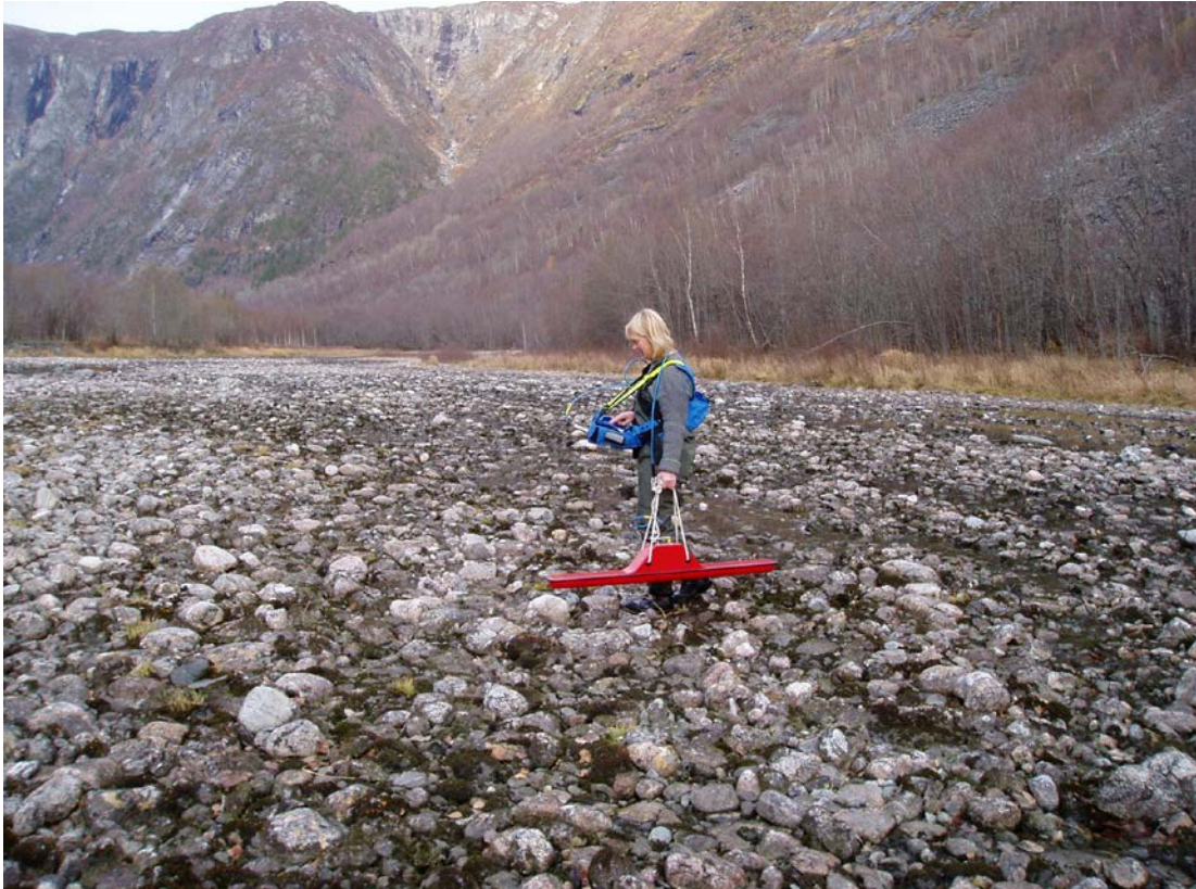
Georadarmålinger vart tatt på langs og tvers av elva.
