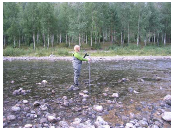
Vannføringsmåling ved Fotopunkt 19. august (0,29 m 3 /s).
