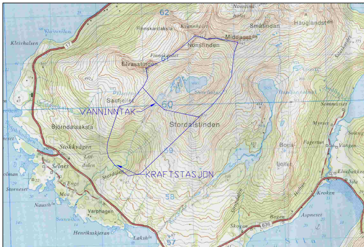
Figur 2.2: Oversiktskart som viser Stordalselvas nedbørsfelt ved vanninntaket samt nedbørsfeltet nedstrøms vanninntaket til kraftstasjonen
