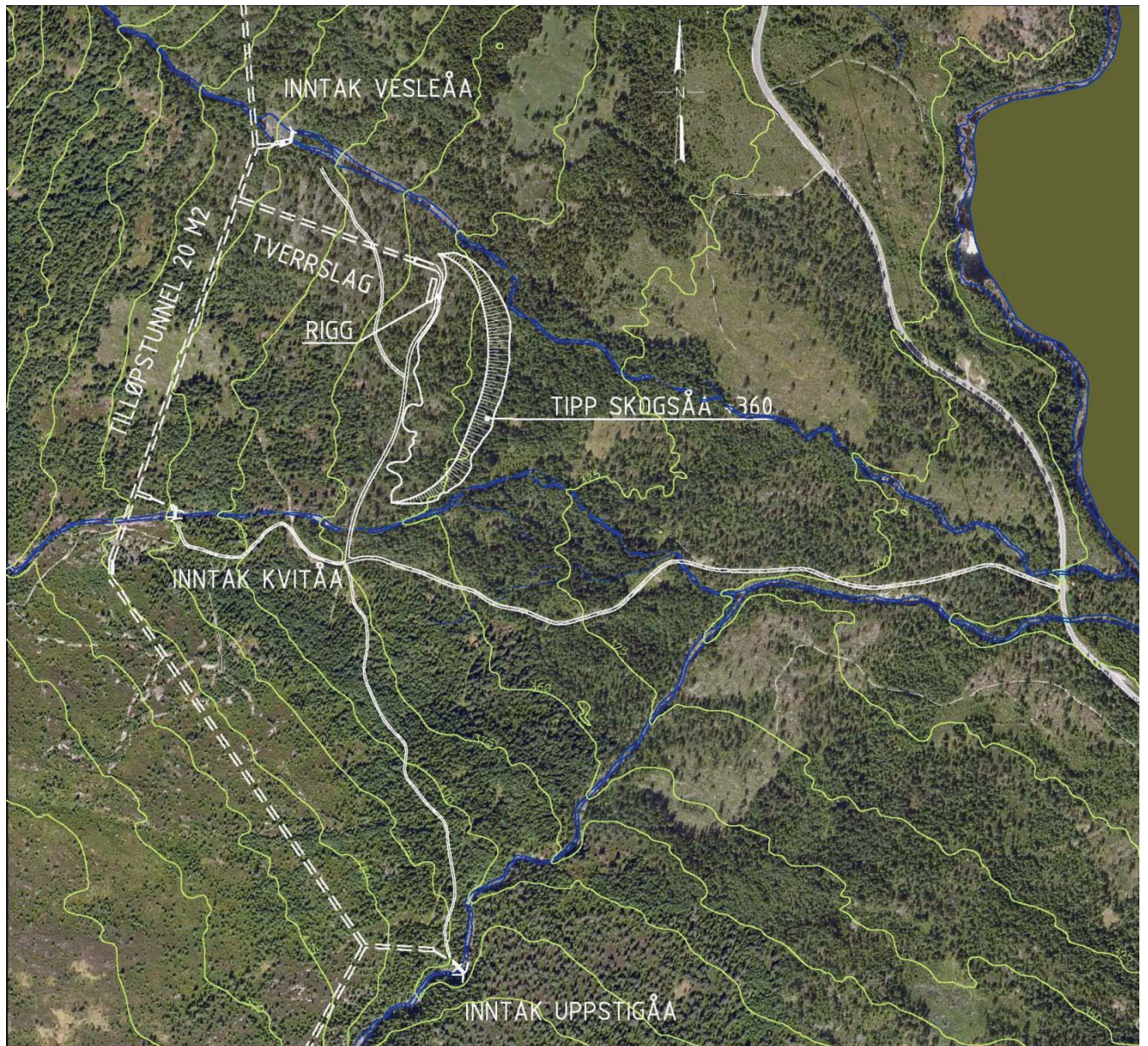
Figur 3-11 Tipp Skogsåa med inntakene i Vesleåa (øverst), Kvitåa og Uppstigåa (nederst). Dobbelt stiplede anleggsdeler ligger i fjellet.
