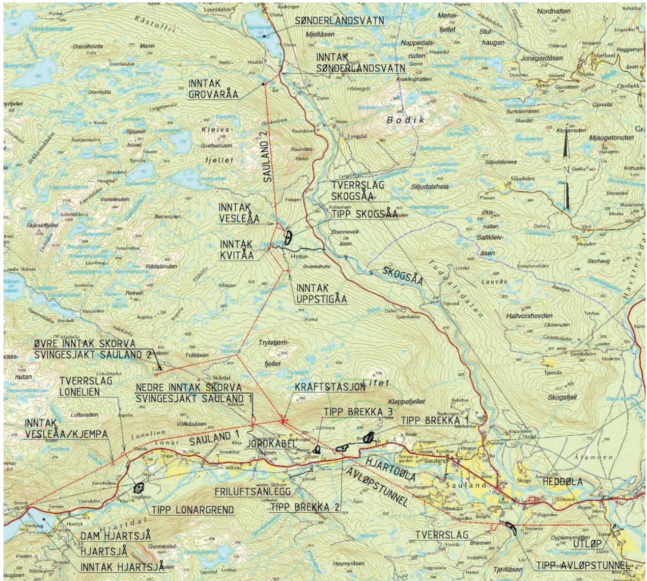
Figur 1-1 Oversikt over planlagt Sauland kraftverk.
