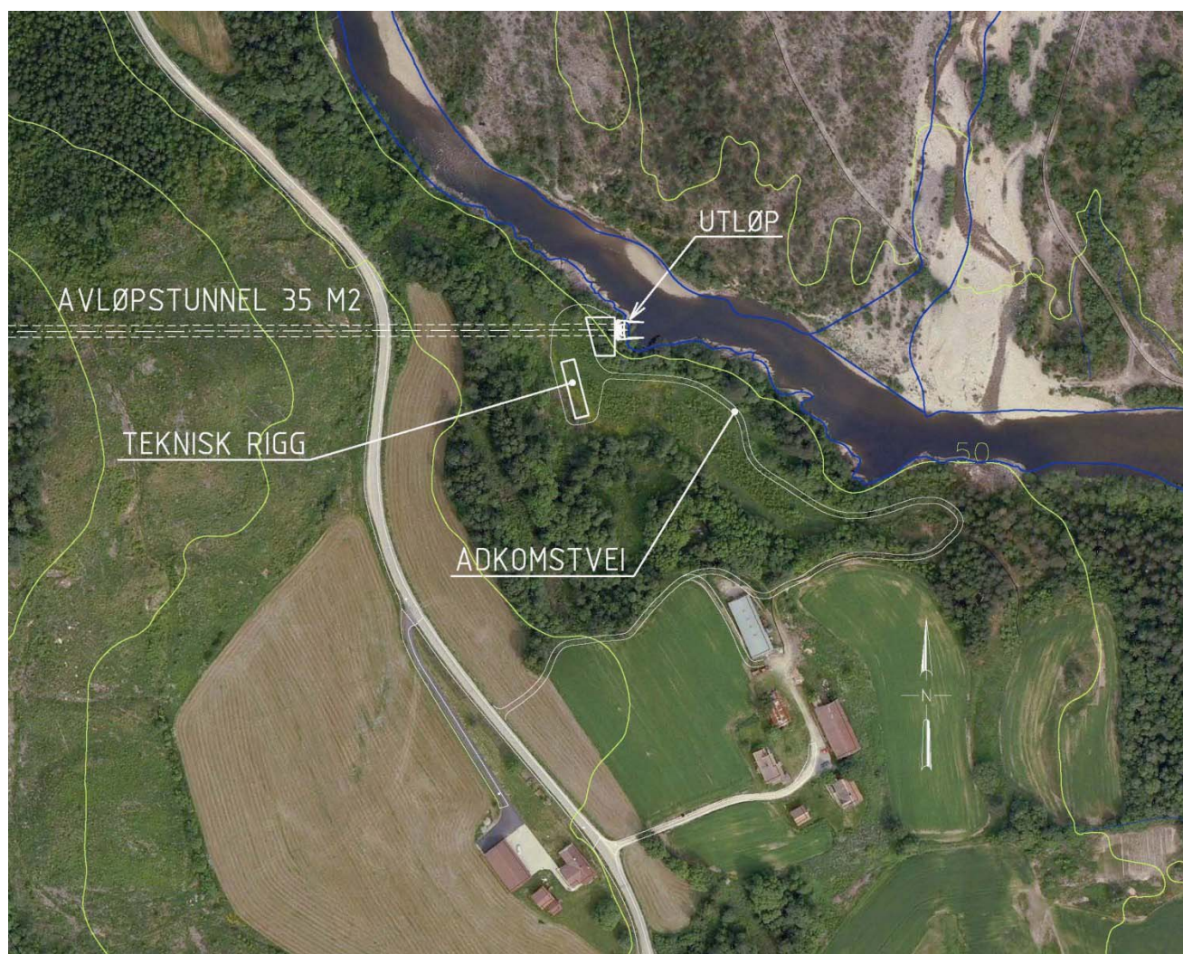
Figur 3-7 Utløp i Heddøla ved Fosse
