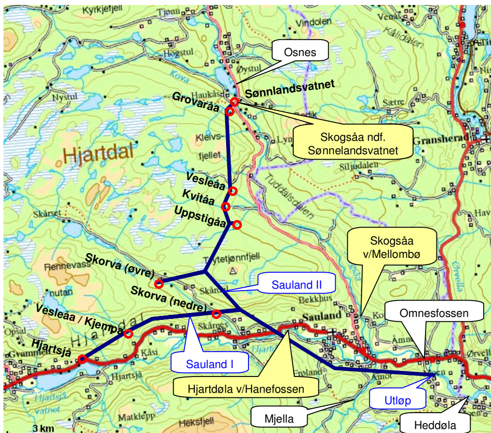
Fig. 2 Kartskisse over utbyggingen. Tunnelene er skissert med blått og inntakspunktene er markert med røde sirkler. Målestedene for vanntemperatur som er plottet i denne rapporten er markert med gul bakgrunn, og stasjonsnavnene er hentet fra NVEs database. Således er Sønderlandsvatnet det samme som Sønderlandsvatn, og Hanefossen det samme som Hanfoss.
