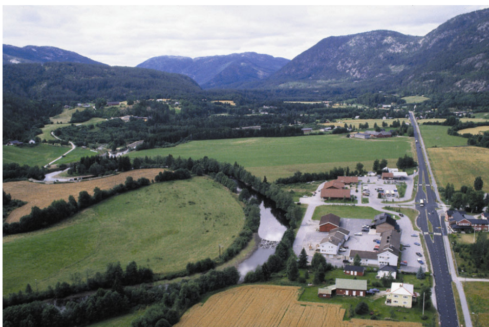
Bilde 9-2: Manipulert bilde av hvordan terskelbygging kan holde et jevnere vannspeil ved Sauland sentrum. Det er viktig at terskelbyggingen gjøres på en måte som gir et mest mulig naturtro inntrykk der overgangssoner/kantsoner og strykpartier formes mer naturlig enn det som kommer frem i denne manipulasjonen. Manipulasjonen er laget av M8 AS.
