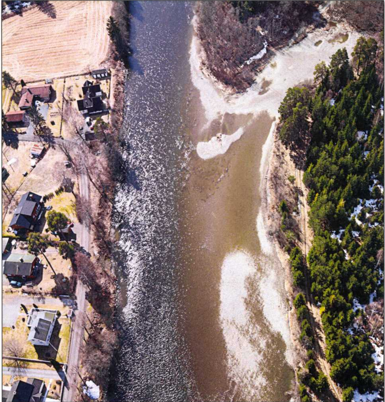
Bilde 9(2) tatt 20. april 2010 ved strekning rett oppstrøms Toenøya, ca. 4 km nedenfor Viul kraftverk, ved en vannføring på 18 m 3 /s, som ble benyttet til å vurdere vanndekket areal.
