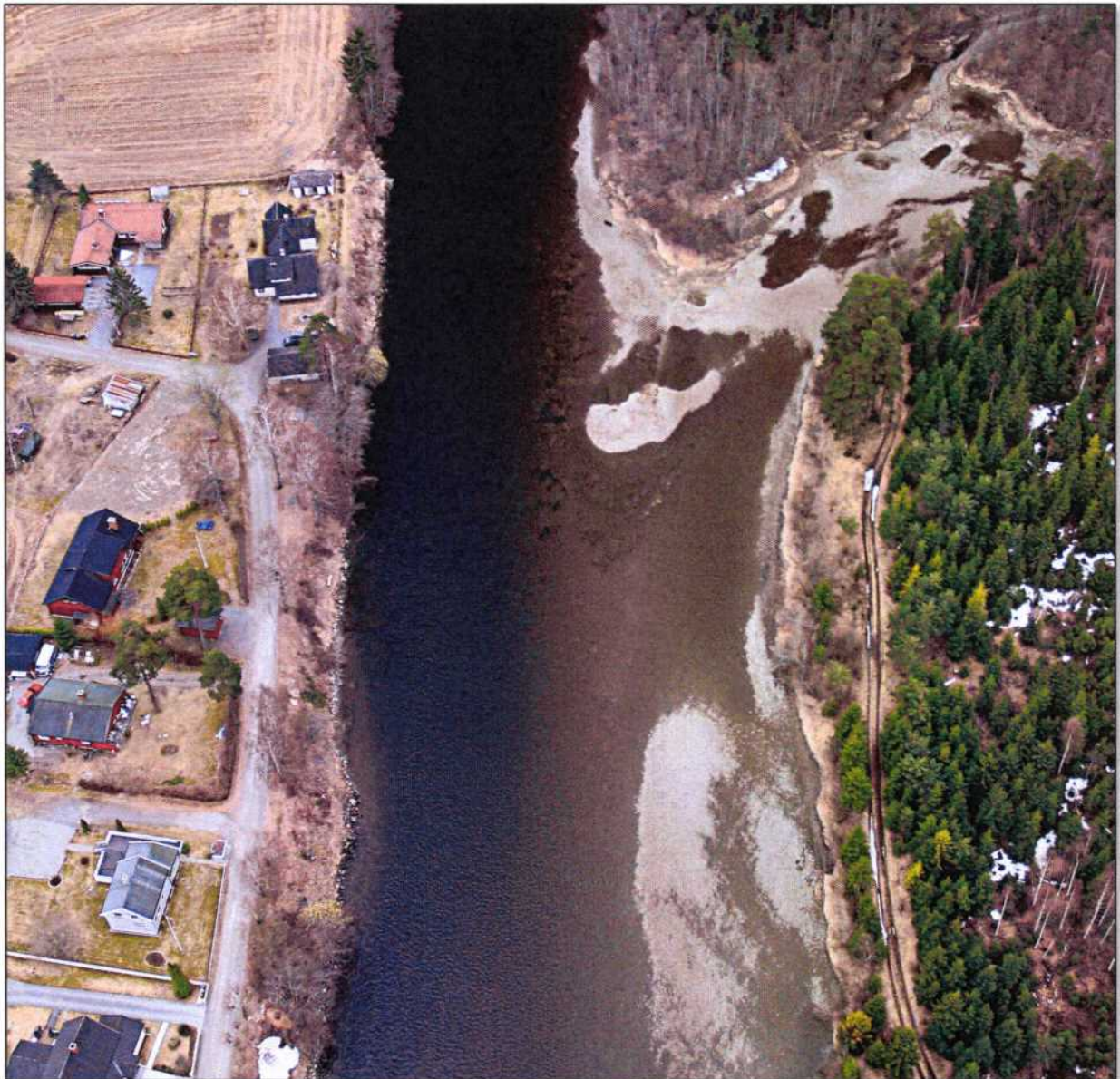
Bilde 9(1) tatt 20. april 2009 ved strekning rett oppstrøms Toenøya, ca. 4 km nedenfor Viul kraftverk, ved en vannføring på 20 \text{ m}^3/\text{s} , som ble benyttet til å vurdere vanndekket areal.
