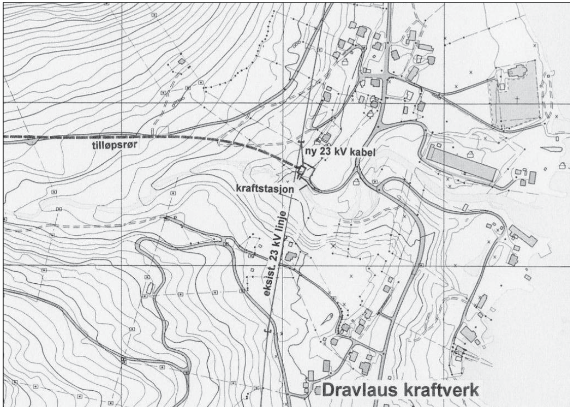
Figur 4. Skisse over nedre del av planområdet i Dravlauselva, Volda kommune. Kraftverket plasseres ved eksisterende inntaksbasseng for settefiskanlegget.
