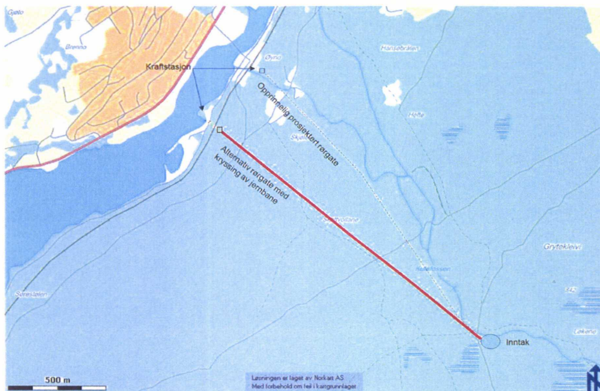
Figur 2: Viser plassering av inntak, rørgate og kraftstasjon for Kulu Kraftverk pr d.d.. Kart mottatt fra Kulu Kraft 16.08.2010.
