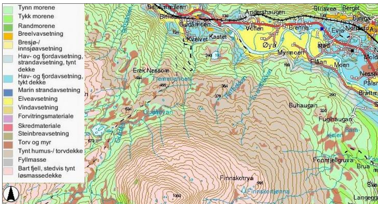
Figur 6. Løsmasser i Gudåas nedslagsfelt.
