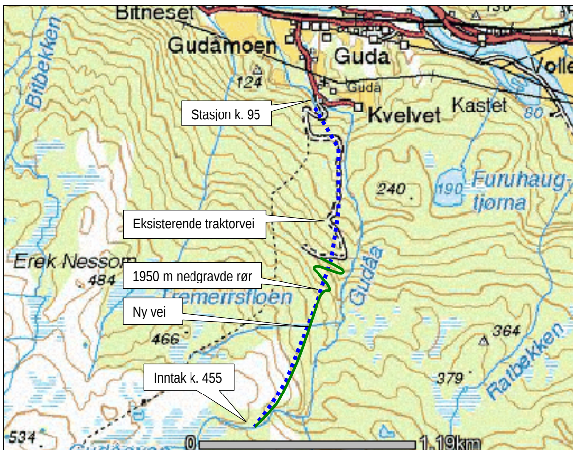
Figur 12 Gudåa kraftverk med stasjon i dagen på k. 95 og nedgravd rørgate opp til inntaket på k. 455.
