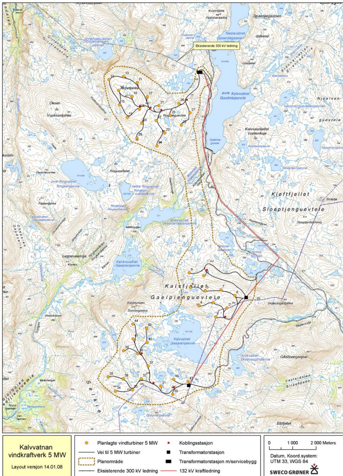
Figur 4-2. Kalvatnan vindkraftverk. Kart over utredet 5 MW alternativ med turbiner, internveier, adkomstvei og nettløsning.
