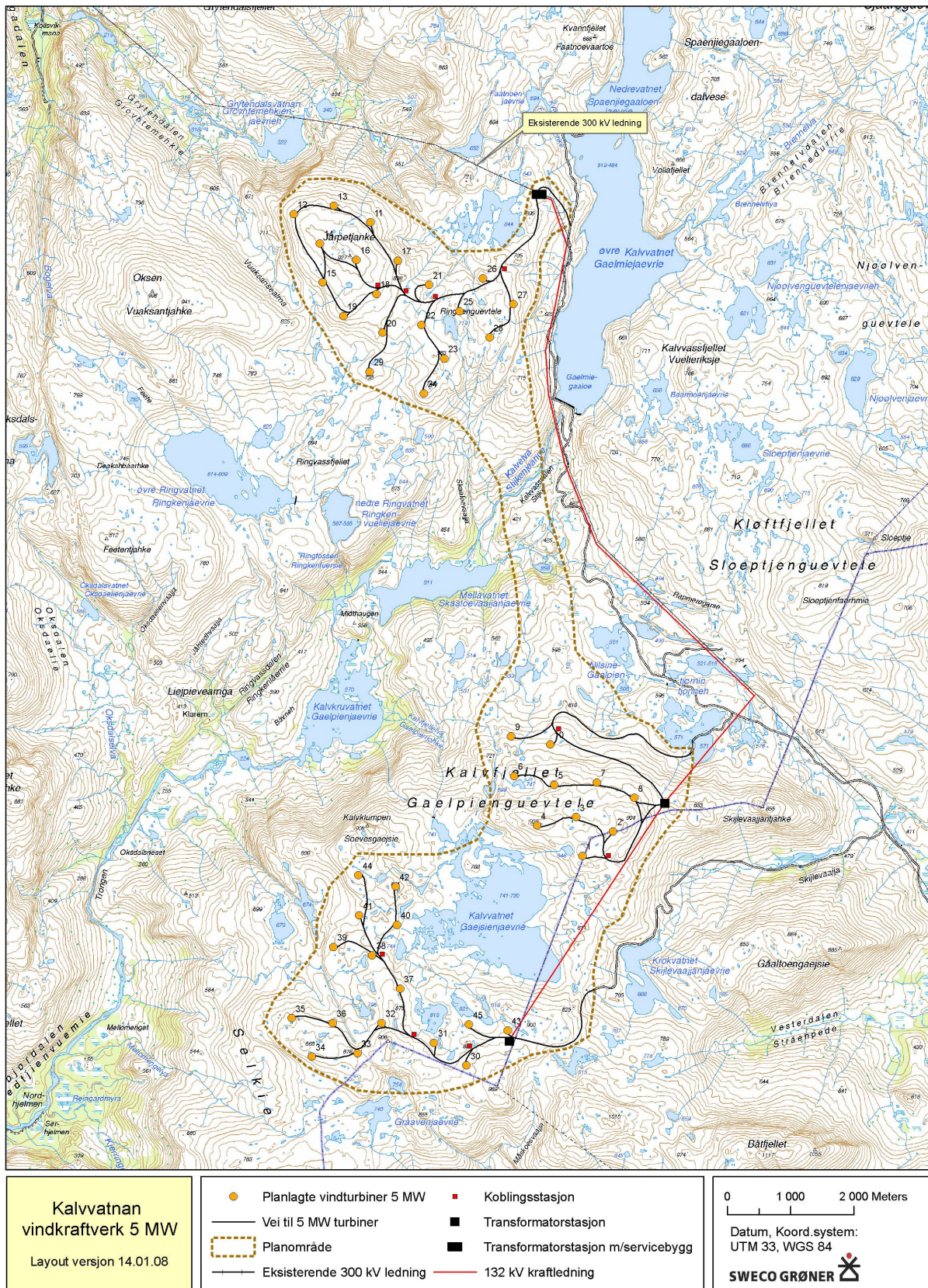
Figur 3: Kalvatnan vindkraftverk. Kart over utredet 5 MW alternativ med turbiner, internveier, adkomstvei og nettløsning.
