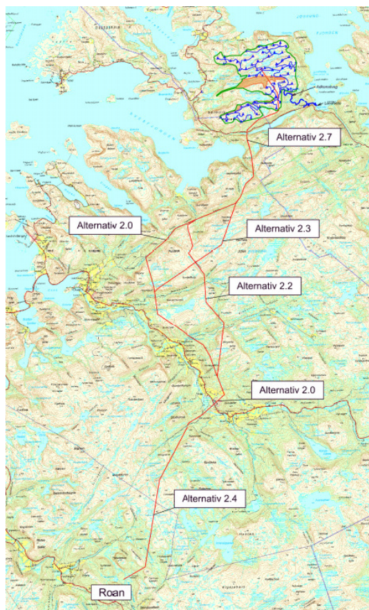
Figur 4: Endret løsning for 132 kV nettilknytning
