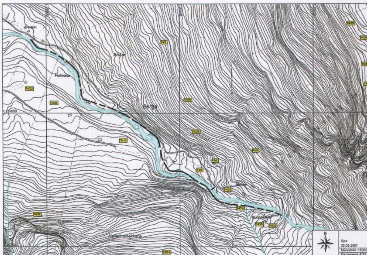
Figur 3. Planlagt røyrgatetrase for Opo kraftverk.
