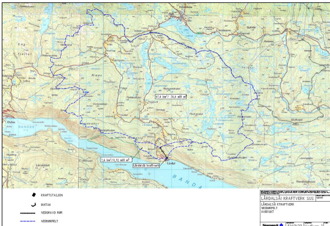
Figur 2. Nedbørfelt, restfelt, driftsvassveg og kraftstasjonsplassering for kraftverk i Lårdalsåi i Tokke kommune. Inntak er planlagt i eksisterende inntaksdam for nedlagd fiske-/smoltanlegg.
