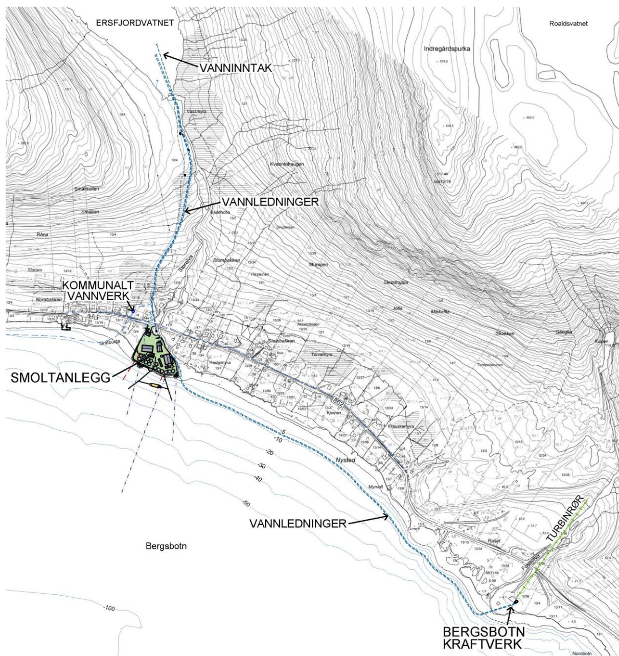
Figur 1.3 Utsnitt av kart med alle vanninntak til Akvafarm AS inntegnet. Se vedlegg 3.2
