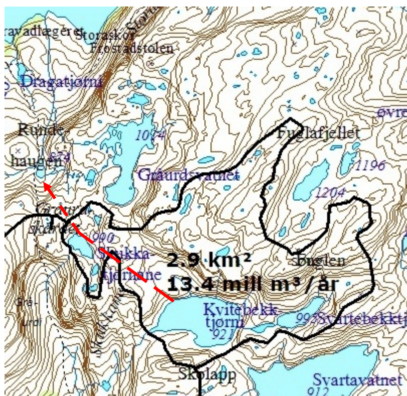
Figur 1 Felt som er planlagt overført til Svartevatn i Samnangervassdraget. (Svartavatnet vist på kartet er et annet Svartavatn) Overføringen er vist med rødt.
