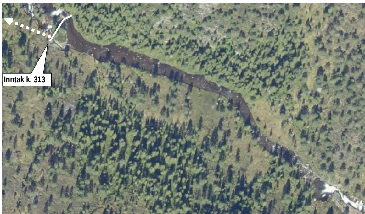
Figur 4 Oppstrøms inntaksområdet i Sagelva renner elva med slakt fall over en strekning på ca. 250 m.
