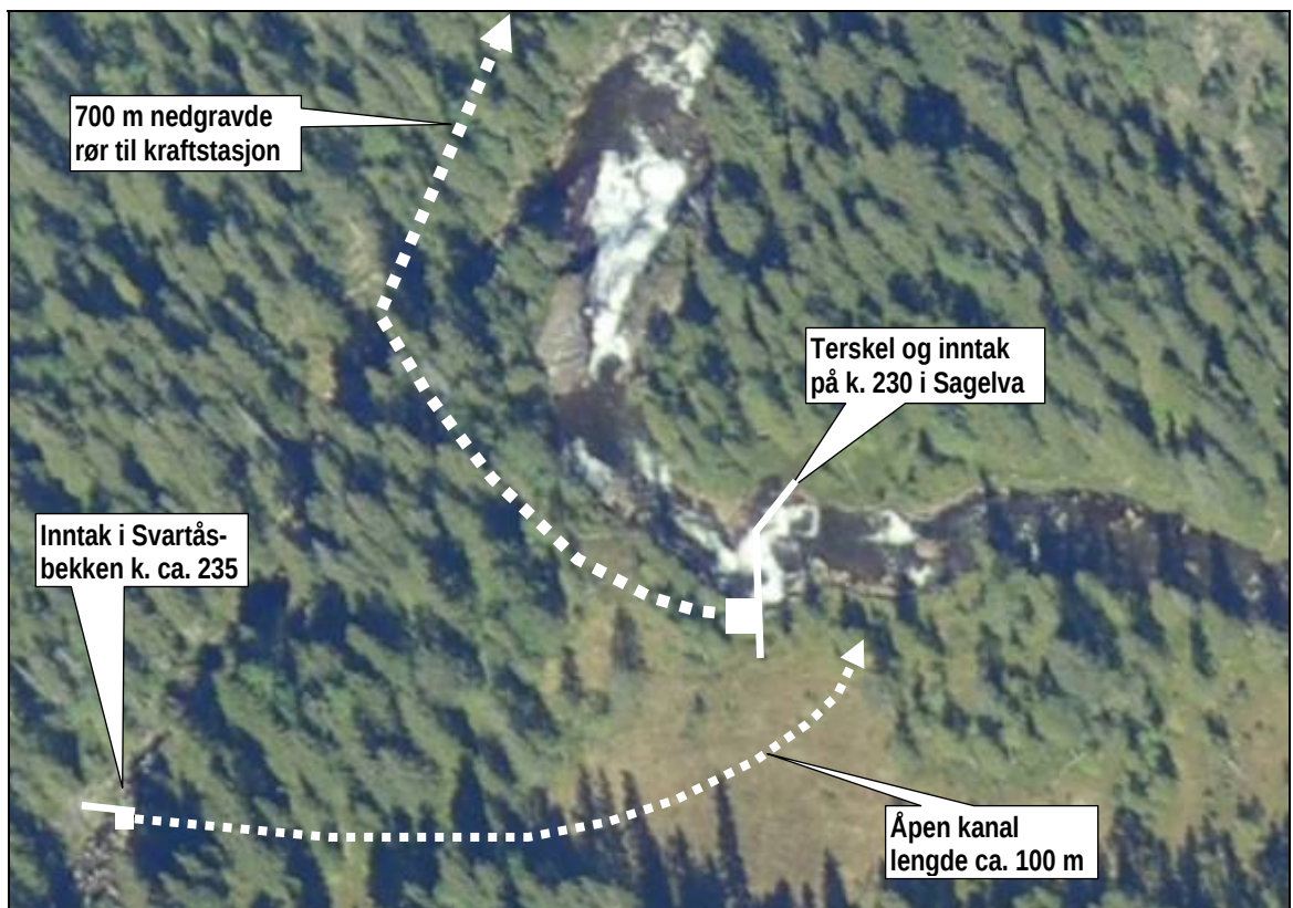
Figur 15 Inntaksområde kote 230 i Sagelva og kote 235 i Svartåsbekken med kanaloverføring til Sagelva.
