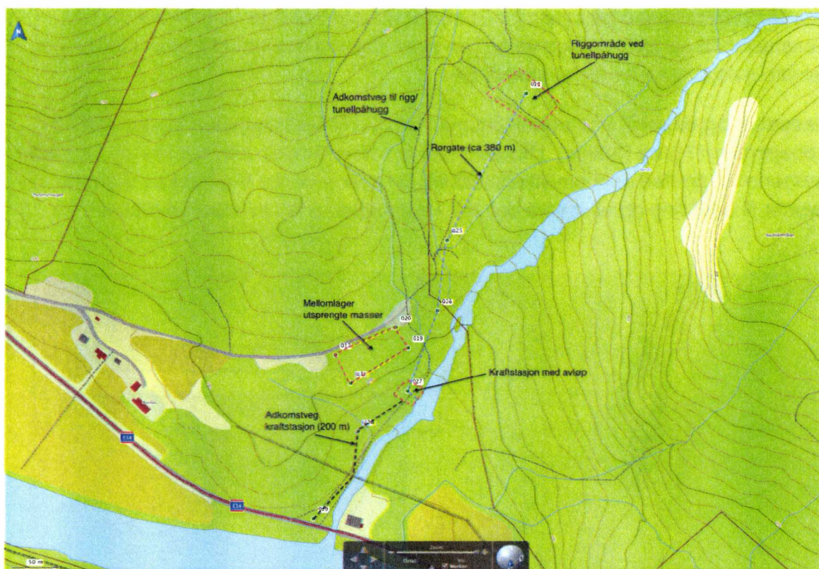
Figur 1. Kartskisser som viser planlagt massedeponi, adkomstveg, trase og profil for tunnel og rørgate
