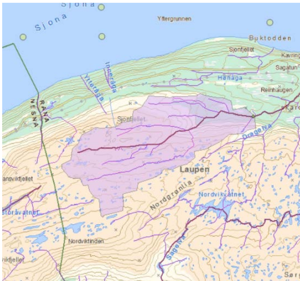
Figur 1. Kart som viser nedbørfeltet til kraftverkets inntakspunkt og restfelt. Kraftverket og inntakspunkt skal og tegnes inn.
