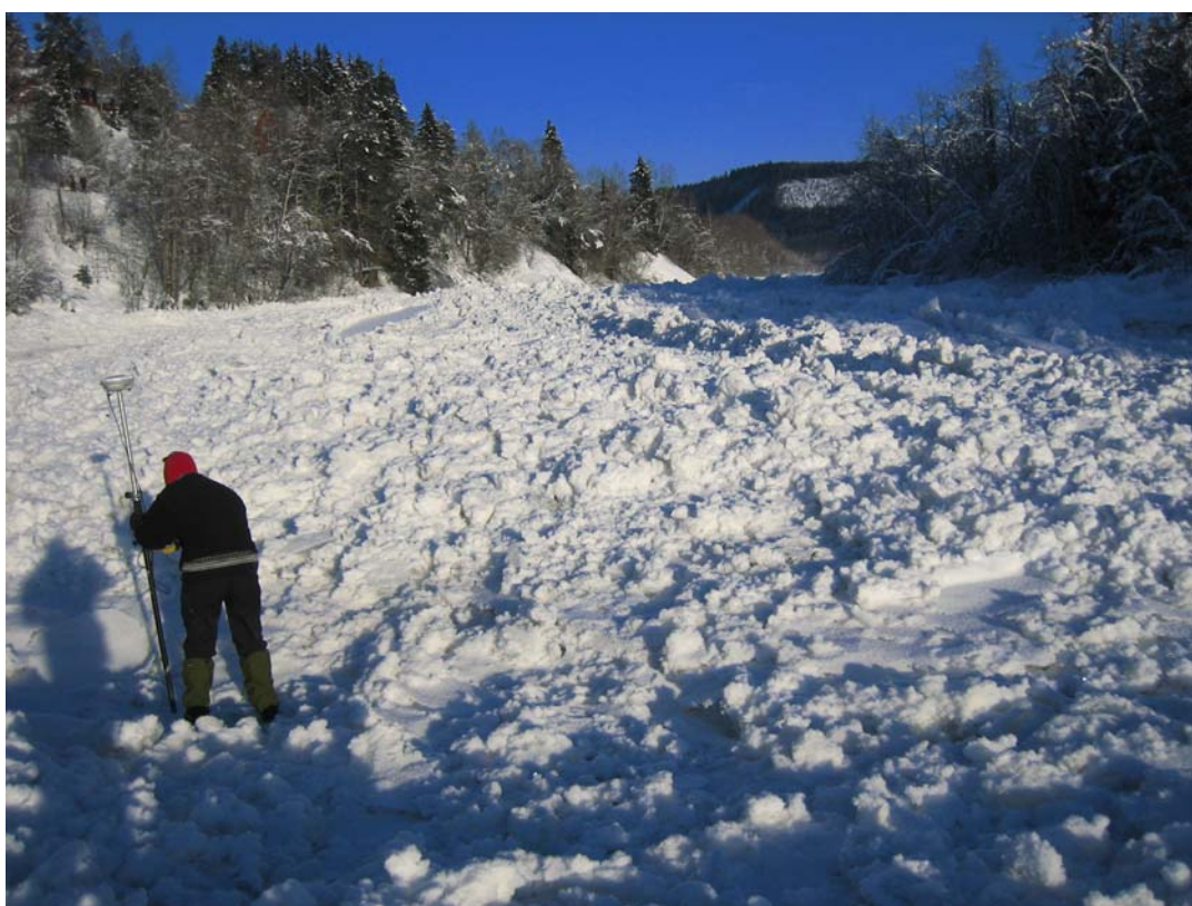
Fig. 11 Isgang i Orkla på minstevannføringsstrekningen mellom inntaket og utløpet av Svorkmo kraftverk. Isgangen skyldtes at kraftverket stanset. Foto: NVE, 13. februar 2007
