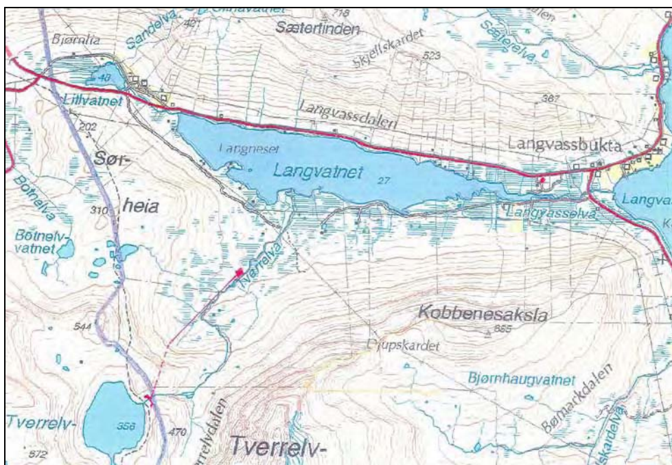
Figur 2.1 Utbyggingsplanene, Tverrelva ved Gulesfjorden i Kvæfjord. Inntak ca. kote 355 eller 345. Kraftstasjon er planlagt på kote 75, alternativt kote 47. På kartet sees Langvassbukta, som ligger på vestsiden av Gulesfjorden, helt til høyre. E10 passerer Langvatnet på nordsiden.
