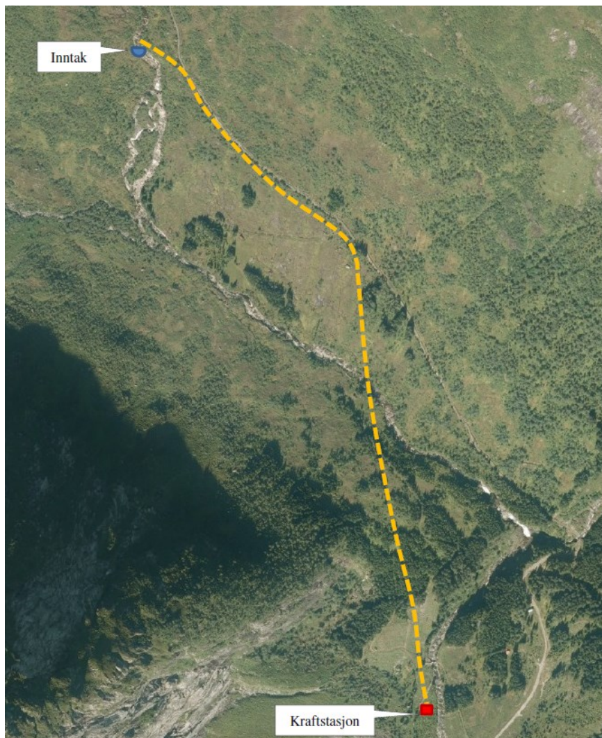
Inntak, rørgate og kraftstasjon vist på flyfoto. Øvrebøfossen til høyre.
