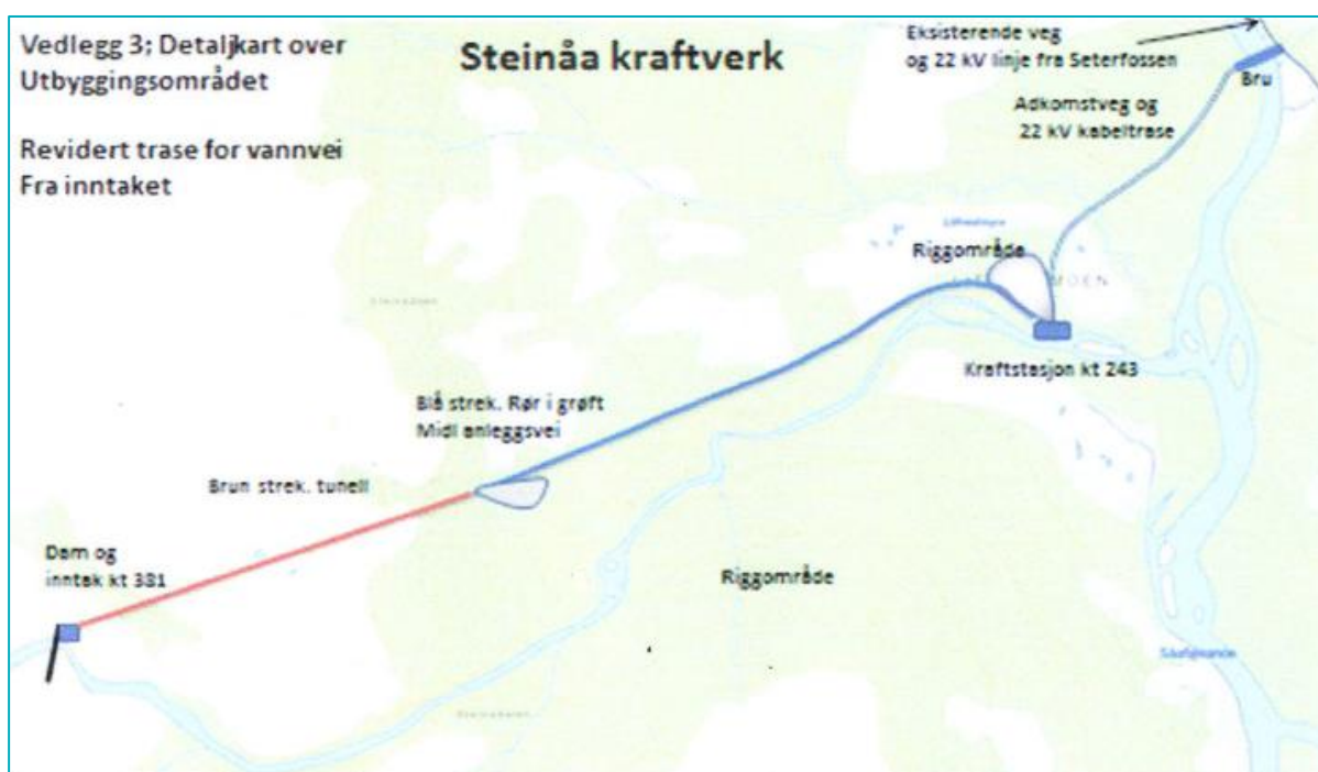
Figur 8: Revidert prosjektskisse for Steinåa kraftverk. Det vil bygges permanent adkomstvei til kraftstasjonen med bru over Nessaelva og nedgravd kabel langs veien.
