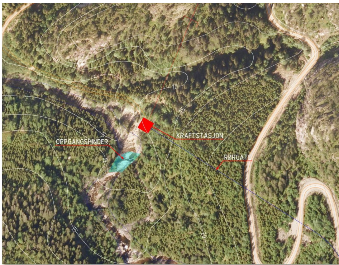
Figur 10 Figuren viser oppgangshinder ved kraftstasjonen. Oppgangshinderet ligger mellom kote +5 og +10.
