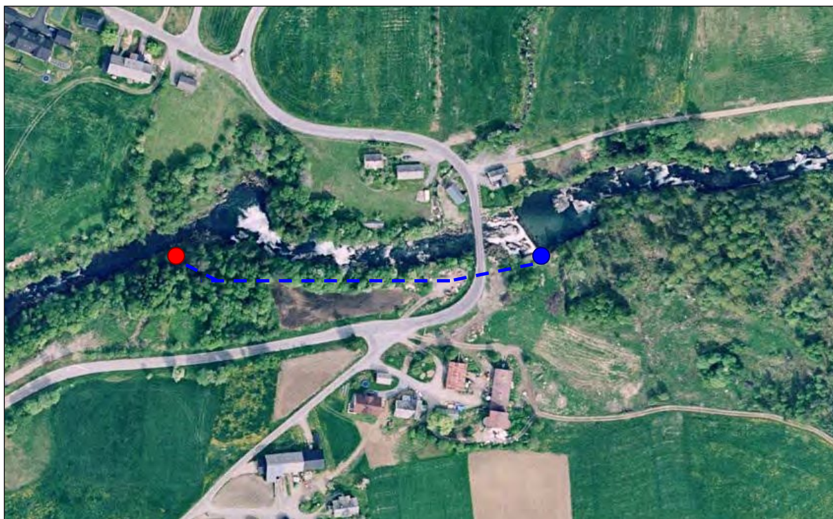
Figur 12. Oversiktsbilde som viser elvestrekningen og arealbruken i området. Lokaliseringen av inntak (blå sirkel), rørgate (blå, stiplet linje) og kraftstasjon (rød sirkel) er angitt. Rv 60 er oppgradert etter at dette bildet ble tatt. Kilde: www.norgeibilder.no
