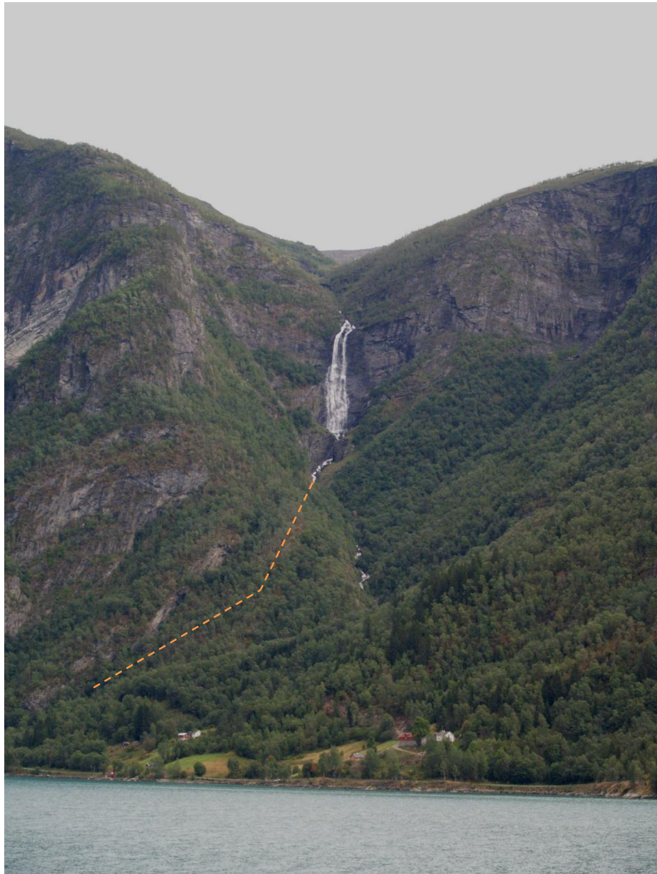
Figur 7B. Mordøla og landskapet rundt med stiplet tunneltrase inntegnet
