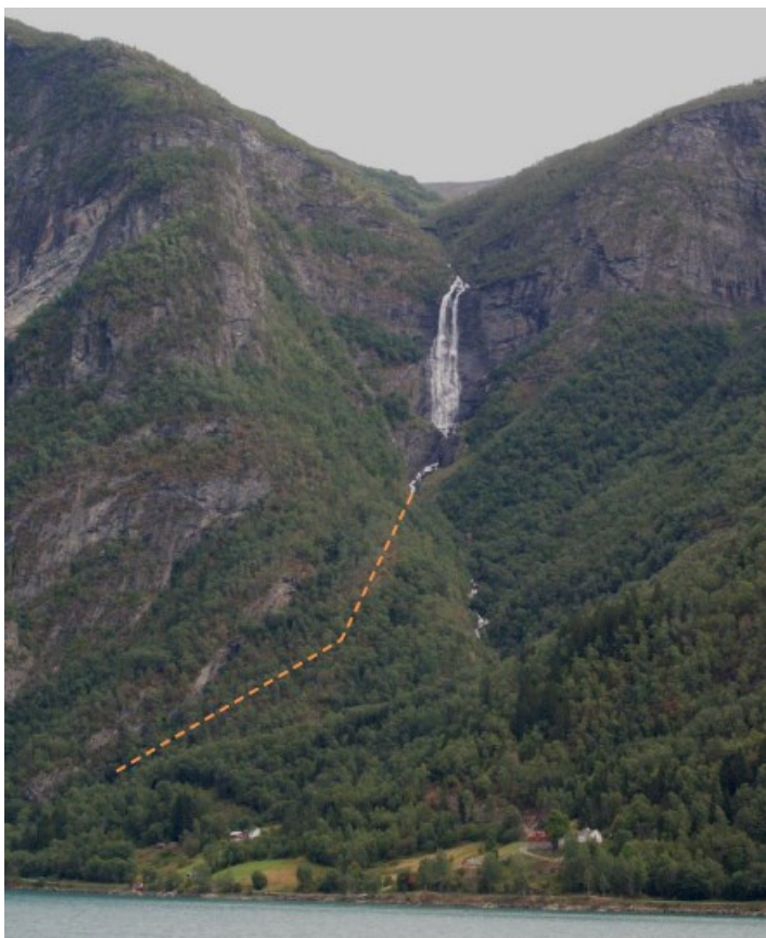
Illustrasjon av trase for sjakt og tunnel.
