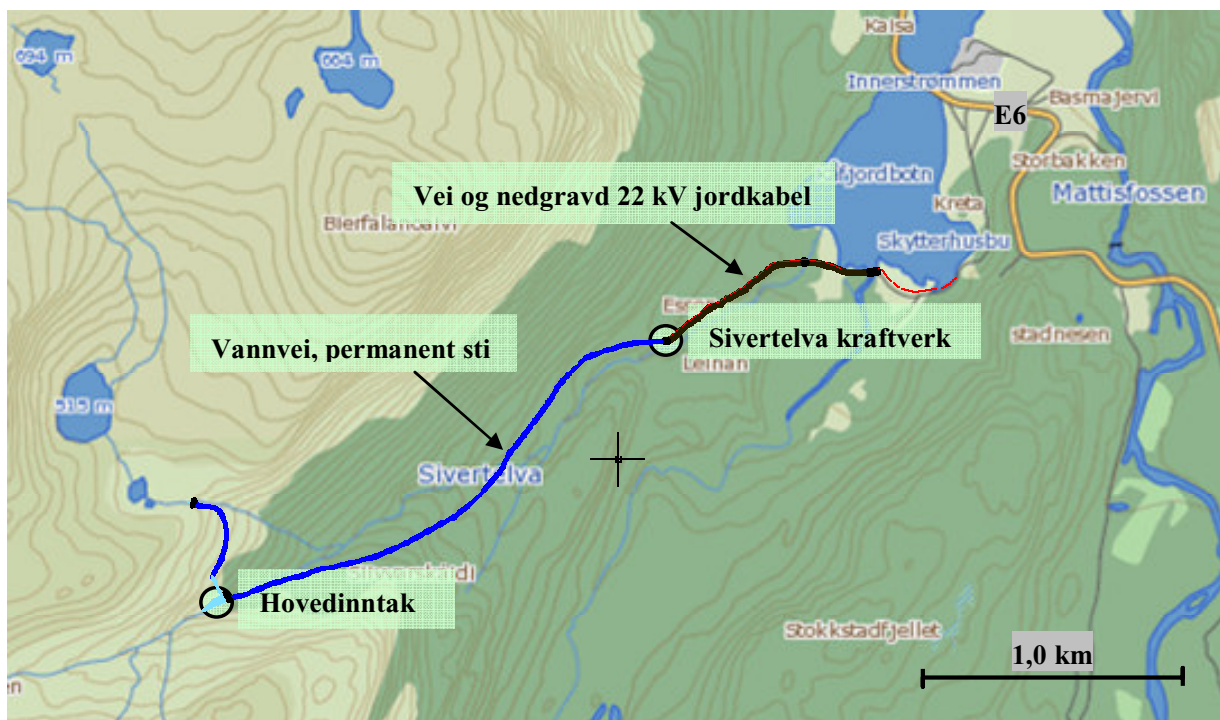
Figur 2-3 Sivertelva kraftverk, oversiktstegning.
