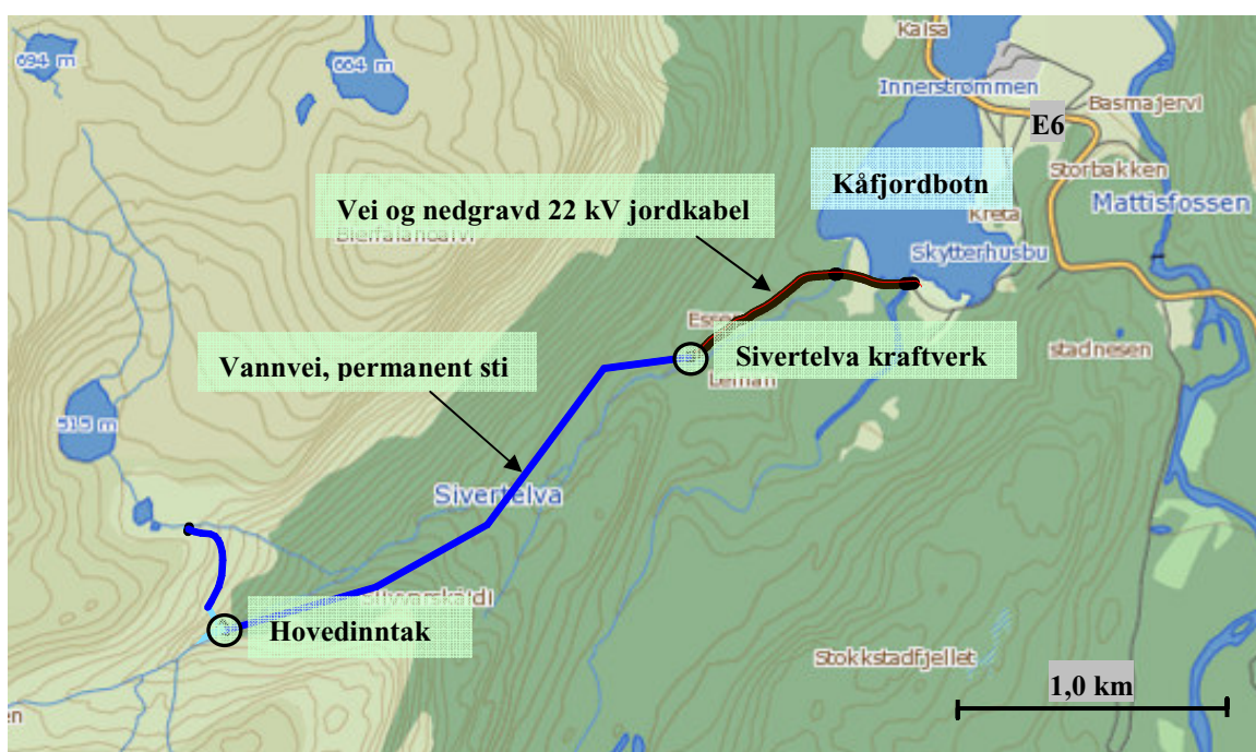
Figur 2-2 Sivertelva kraftverk, oversiktstegning.
