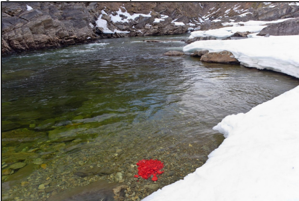
Figur 4.29. Utlagt fargetet grus på grusområde 2, 50 – 60 m nedstrøms samløpet med Bjellåga. Foto 29.04.2014
