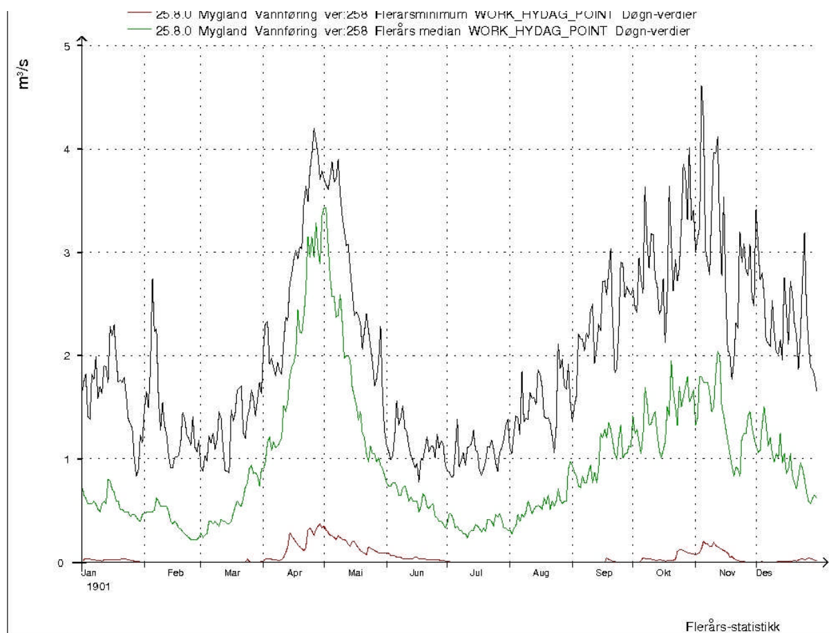
FIGUR 5: KURVEN VISER ESTIMAT FOR SESONGVARIASJONEN I VANNFØRINGEN I M 3 /S I LITTLEÅNA BASERT PÅ FLERÅRS DØGNVERDIER. FLERÅRSMIDDEL, FLERÅRSMEDIAN OG FLERÅRSMINIMUM.
