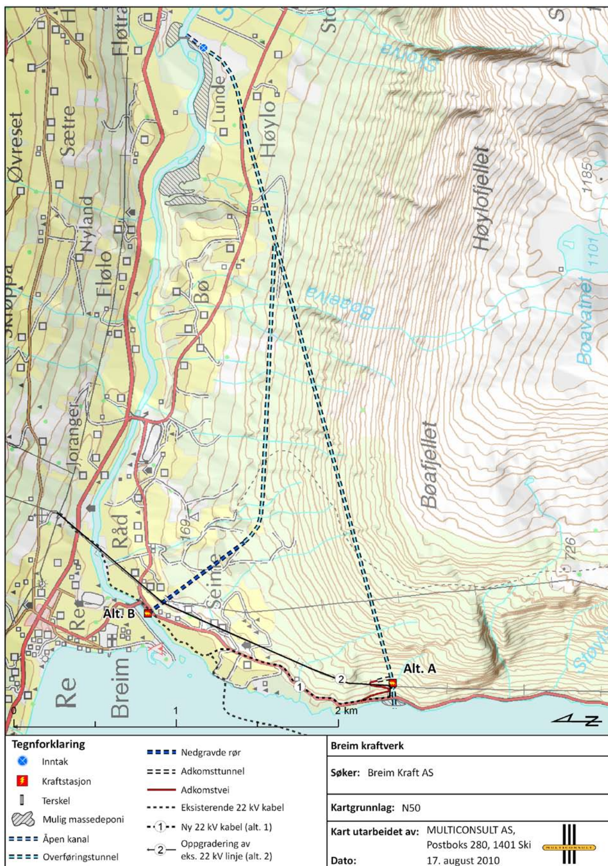
Figur 1. Oversikt over vurdert utbyggingsalternativer. Alternativ B er i konsesjonssøknaden vurdert som teknisk svært vanskelig og dyrt, og tiltakshaver har derfor valgt å ikke omsøke dette alternativet.
