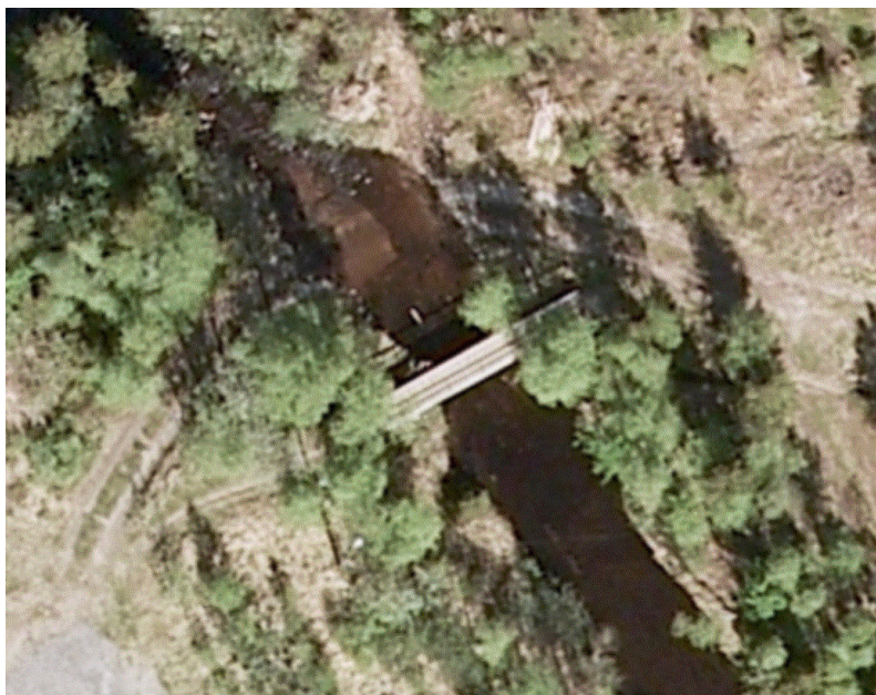
Figur 14: Alternativ plassering av reguleringsdam foreslås der traktorvegen krysser Kvernbekken. Se for øvrig kart og foto i vedlegg.
