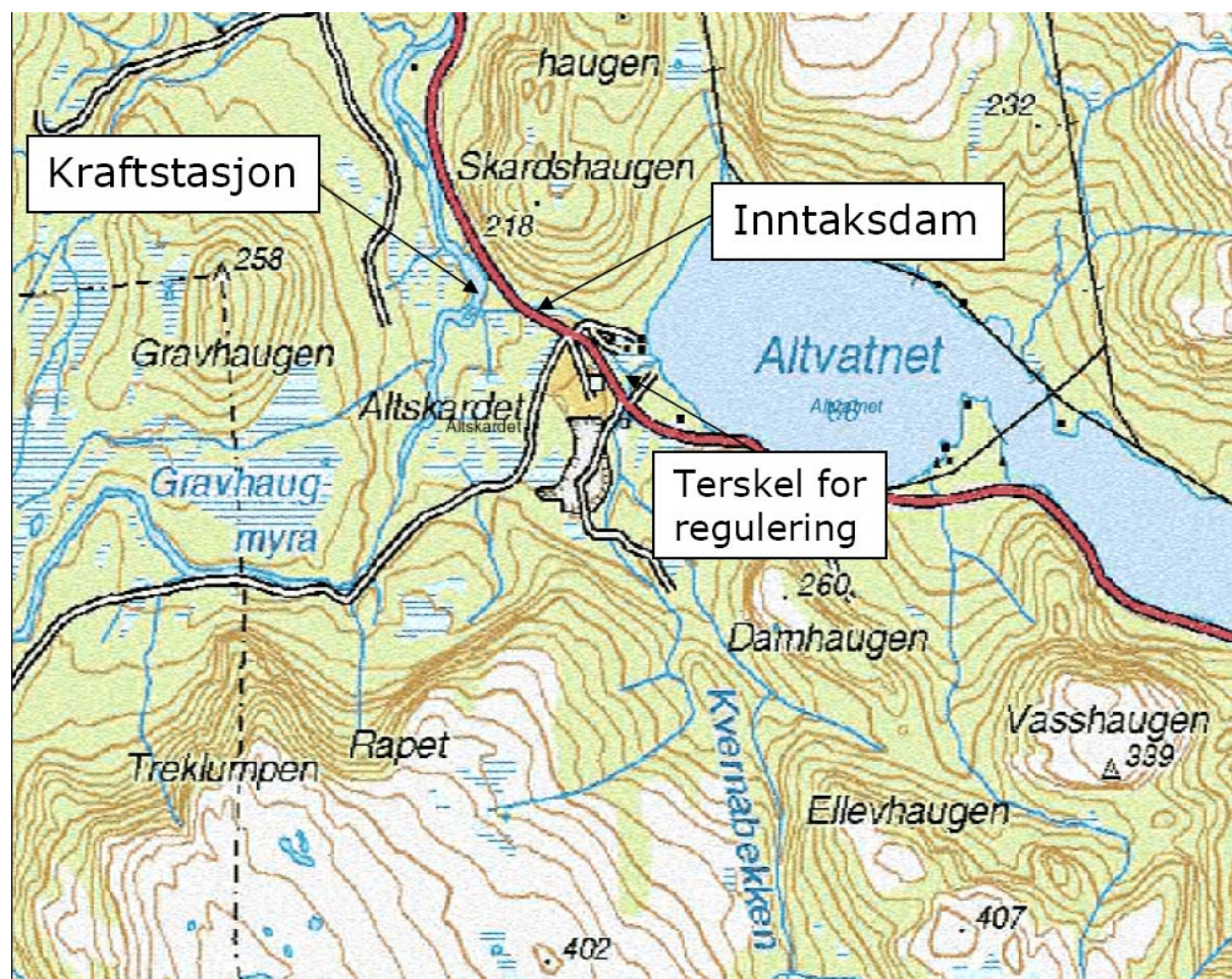
Figur 2.2. Oversiktskart, Kvernbecken småkraftverk
